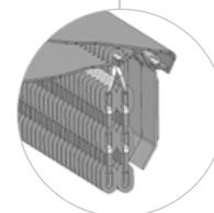
Комбинированная защита: защитные пластины отклоняются и смещают цепи, создавая барьер, предотвращающий застревание материала между звеньями цепей; Цепи препятствуют выбросу камней.
