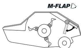
Опционально: Открывающийся регулируемый капот на корпусе для настройки степени измельчения, доступный также в гидравлической версии
