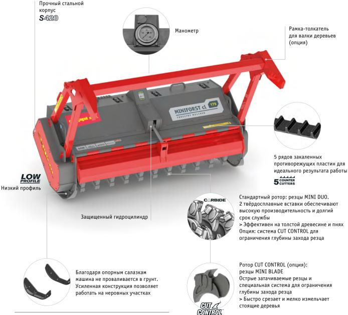
Предупреждение о безопасности: MINIFORST cl нельзя поднимать выше чем на 50 см от уровня земли. Разрешается работать только на погрузчиках с ударопрочным остеклением/защитой от камней.
