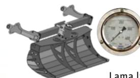
Lama livellatrice (optional), regolabile in altezza e ruotabile, con ammortizzazione idro-pneumatica, completa di estensioni - Manometro per il controllo della pressione di contatto della lama livellatrice
