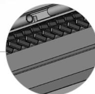
Telaio rinforzato con piastre antiusura intercambiabile 5 file di controlame temperate per un risultato di lavoro perfetto
