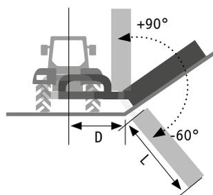
La trincia può essere inclinato di 90° verso l'alto e inclinato di 60° verso il basso
