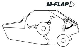
Cofano apribile e regolabile, sotto il telaio, come optional, per determinare il grado di triturazione, disponibile anche in versione idraulica
