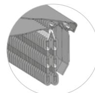
Protezione combinata: le bandelle si inclinano e spostano le catene, creando una barriera che impedisce al materiale di incastrarsi tra le maglie delle catene, le catene proteggono dalla proiezione dei sassi
