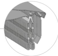
Protezione combinata: le bandelle si inclinano e spostano le catene, creando una barriera che impedisce al materiale di incastrarsi tra le maglie delle catene, le catene proteggono dalla proiezione dei sassi
