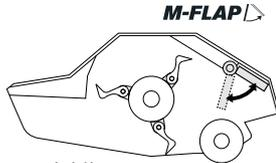
Cofano apribile e regolabile, sotto il telaio, come optional, per determinare il grado di triturazione, disponibile anche in versione idraulica
