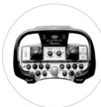
Radiocomando con display grafico controlla tutte le funzioni del veicolo; la gamma di frequenza è di 2,4 GHz e copre distanze fino a 160 m.
