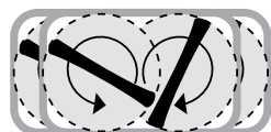
Lame taglienti sovrapposte per un taglio sempre uniforme, indipendentemente dalla larghezza di taglio
