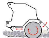
Barra e griglia di frantumazione regolabile per regolare il grado di sminuzzamento
