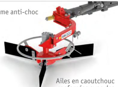
Ailes en caoutchouc renforcées avec des ressorts
