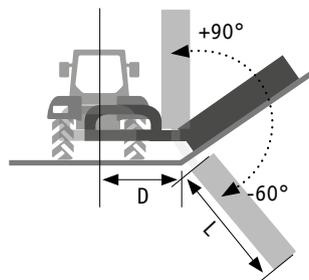
La broyeur peut être inclinée à 90° vers le haut et 60° pour être incliné
