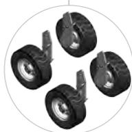
4 roues d'appui permettent à la machine d'être stable sur les sols irréguliers et pierreux
