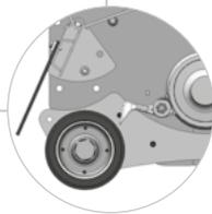
Rouleau positionné très proche du rotor. Il va donc être nettoyé par les marteaux et le matériel broyé est mieux évacué au dessus du rouleau.
