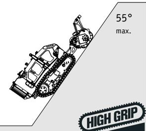
Estabilidad y agarre del vehículo en terrenos difíciles, con pendientes de hasta 55° en condiciones óptimas
