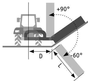
La trituradora se puede inclinar 90° hacia arriba y 60° para estar inclinado
