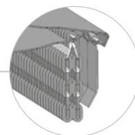
Protección combinada: los goznes se inclinan y mueven las cadenas, creando una barrera que impide que el material quede atrapado entre los eslabones de las cadenas, las cadenas protegen de la proyección de piedras
