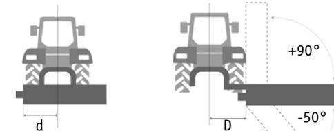
Desplazamiento lateral hidráulico [D] hasta 112 cm con multiplicador externo opcional hasta 139 cm [d] 65 cm o 38 cm con multiplicador externo
