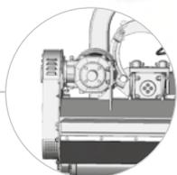
El multiplicador en el interior permite mantener la máquina cerca del tractor
