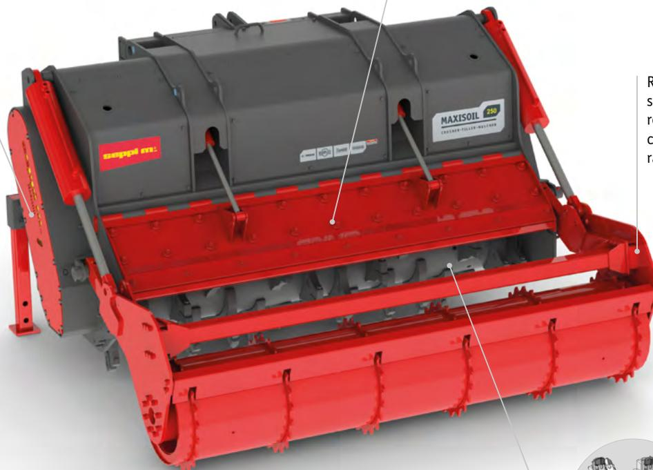
Rodillo compactador del suelo (opcional). El rodillo realizado se puede usar como bajador de ramas; con raspador de rodillo
