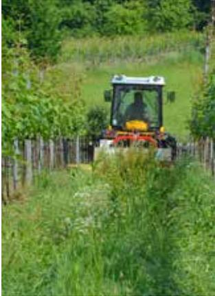
El perfil muy bajo de las trituradoras de cuchillas giratorias permite trabajar en viñedos y frutales sin hacer daño a la fruta. El corte es preciso y la hierba triturada se distribuye de manera uniforme.
