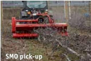
Con el uso de las trituradoras pick-up ya no es necesario recoger los restos de poda, ya que estos se trituran muy finamente. Esto permite una rápida descomposición del picado en un solo ciclo de cultivo.
