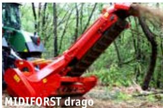
Una solución óptima para recoger el material triturado, tanto hierba como madera, para uso en el sector energético, para producir biomasa o sencillamente para la limpieza del campo, del bosque o de áreas verdes.
