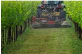
La inclinación hidráulica junto al desplazamiento lateral hacen este equipo muy versátil.
