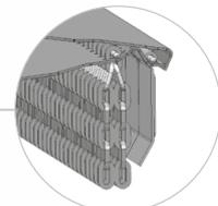
Protección combinada: los goznes se inclinan y mueven las cadenas, creando una barrera que impide que el material quede atrapado entre los eslabones de las cadenas, las cadenas protegen de la proyección de piedras
