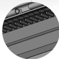
Rotor de martillos fijas; herramientas con insertos de carburo de tungsteno; 5 filas de contracuchillas templadas para un trabajo con resultado perfecto
