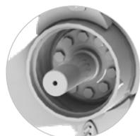
Bujes del rotor intercambiables
