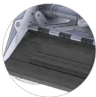
Bisagras la longitud completa en el capó para la estabilización
