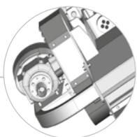
Ein außen angebautes Getriebe sorgt für eine größere Seitenverschiebung (Option bei 175-200 cm)
