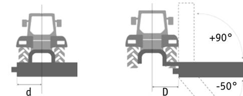
Hydraulische Seitenverschiebung [D] bis 112 cm mit optionalem externen Getriebe bis 139 cm [d] 65 cm bzw. mit externem Getriebe 38 cm
