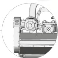
Getriebe auf der Innenseite ermöglicht das Gerät nahe am Traktor zu halten (bei Arbeiten in Obstanbau-Reihen)
