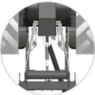
Option: Stabiler und komfortabler Anbau mit dem PENTALINK Stabilisierungssystem
