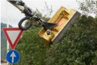
Die Kombination von Bagger und Mulchgerät ermöglicht es, auf unwegsamen oder schwer erreichbaren Lagen, auf steilen Hängen, unebenen Flächen oder in Sumpfbereichen zu mulchen. Sie sind ausgezeichnete Geräte für die Landschaftspflege, für die Pflege von Kanälen und Flussufern, von Strom- oder Gasleitungen.
