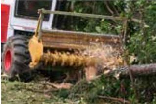
Diese Mulchgeräte wurden speziell für hydraulische Fahrzeuge entwickelt. In dieser Kombination erreichen sie steile und unwegige Stellen, bei denen das Mulchen ansonsten sehr schwierig oder gar unmöglich wäre.
