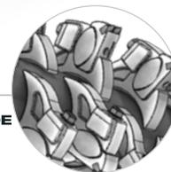
Rotor mit festen Werkzeugen mit Wolframkarbid-Bestückung und verschleißfester Werkzeughalterung; 5 Reihen Gegenschneiden verbessern das Mulchergebnis
