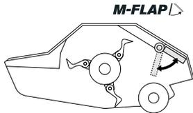
Optionale einstellbare Haube unter dem Chassis, zum Bestimmen des Zerkleinerungsgrades, mechanisch oder hydraulisch lieferbar
