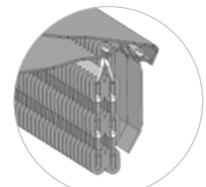
Kombinationsschutz: die Klappen verhindern ein Verheddern von Reisig in den Ketten, das Material wird so reibungslos in die Rotorwelle eingezogen, die Ketten schützen vor Steinauswurf
