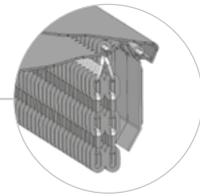
Kombinationsschutz: die Klappen verhindern ein Verheddern von Reisig in den Ketten, das Material wird so reibungslos in die Rotorwelle eingezogen, die Ketten schützen vor Steinauswurf
